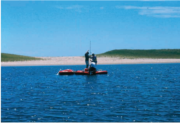
Kam-biu Liu and his students coring a coastal lake in Cape Cod, Massachusetts, for a paleotempestology study, in front of an overwash fan. // Kam-biu Liu y sus estudiantes tomando muestras de fondo de una laguna costera en Cape Cod, Massachusetts, para un estudio de paleotempestología. Al fondo, un abanico de derrame.
